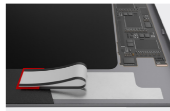
元器件的临时固定
