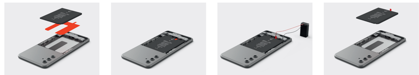
使用德莎按需解粘胶带将电池固定至智能手机壳体。 在实现强劲可靠粘接的同时，具备出色的抗跌落冲击性能。 施加低电压即可激活解粘功能。 从而实现电池的快速、洁净拆卸。
